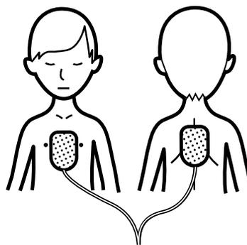
**Benutzen Sie Kinder-/Säuglingselektroden für Säuglinge und Kinder, die jünger als 8 Jahre sind oder weniger als 25 kg (55 Pfund) wiegen** (*Hinweis: Bei Kinder-/Säuglingselektroden sind Elektrodenpackung und Stecker blau gefärbt*): Kleben Sie, wie abgebildet, jeweils eine Elektrode auf die Mitte der Brust und auf die Mitte des Rückens. Nutzen Sie die Abbildung auf der Elektrode zur Bestimmung des Anbringungsorts der Elektroden.
