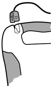
Setzen Sie, wie abgebildet, den Stecker des Elektrodenkabels in den dafür vorgesehenen Elektrodeneingang links oben am AED ein. Führen Sie den Elektrodenstecker fest ein, bis er vollständig in dem Gerät sitzt.
