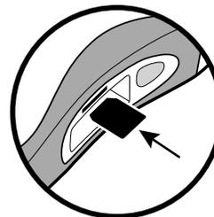
6. Stellen Sie sicher, dass die Kartenanwendung vollständig ausgeführt wurde und dass der AED abgeschaltet ist. Entnehmen Sie den Batteriepack, dann die Datenkarte und setzen Sie anschließend den Batteriepack wieder ein. Der AED führt daraufhin möglicherweise einen Batteriepackselbsttest durch und schaltet sich anschließend aus.
