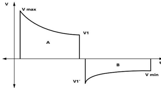
Die Wellenform wird angepasst, um die gemessene Patientenimpedanz zu kompensieren. Die nominale Phasendauer und abgegebene Energie sind in der nachstehenden Tabelle aufgeführt.
