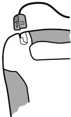
Der AED DDU-100 ist so konzipiert, dass er mit bereits an das Gerät angeschlossenen Elektrodenstecker aufbewahrt werden kann, während die Elektroden selbst in der Verpackung versiegelt bleiben. Dies reduziert den Zeitaufwand für die Vorbereitung und den Beginn der Behandlung in einem Notfall.
