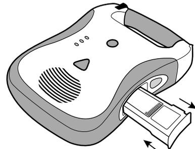
Um den Batteriepack zu entfernen, drücken Sie die Entriegelungstaste seitlich am AED. Nachdem der Batteriepack ein Stück aus dem Gerät geschoben wurde, ziehen Sie es vollständig heraus.
