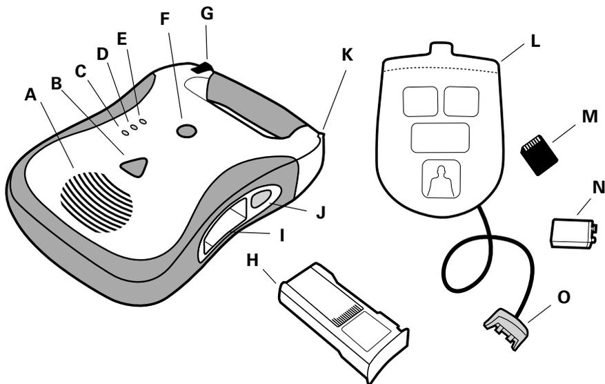
\*Auch ohne die 9V-Batterie für die Aktivitätsstatusanzeige wird der AED DDU-100 im Standbymodus ausgeführt, allerdings wird hierdurch die Lebensdauer des Batteriepacks beeinträchtigt.
